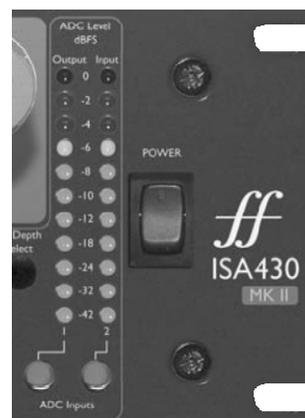
Dos medidores de barra de LED's monitorizan el nivel de salida (izquierdo) y entrada (derecho) de la unidad.
