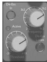
El de-esser utiliza un diseño óptico, permitiendo al usuario eliminar las sibilancias excesivas de una reproducción vocal (dónde los sonidos "ess" se suelen sobre-enfatizar).
