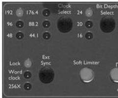
Pulsar para activar el soft limiter. El circuito soft limiter actúa incrementando gradualmente el ratio del limitador tal como la señal ha superado el threshold. El threshold está fijado a +6dBFS (+16dBu). Señales de nivel entre -6dBFS y -4dBFS tienen un ratio de 1.5:1, las señales entre -4dBFS y 0dBFS tienen un ratio de 2:1, y las señales de nivel entre 0dBFS y +6dBFS tienen un ratio de ∞:1.
